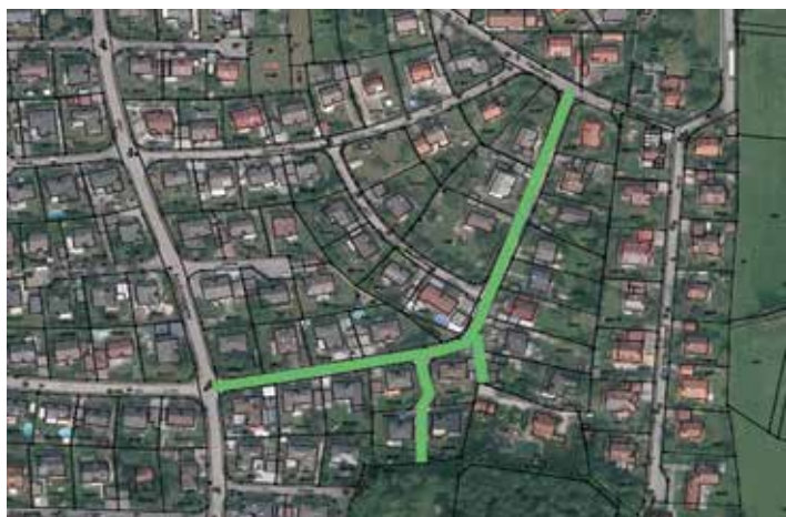
Adlerstraße Pyrbaum: In den grün markierten Bereichen werden die Wasserversorgungsleitungen erneuert.
