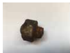
Eine der abgerosteten Schrauben
