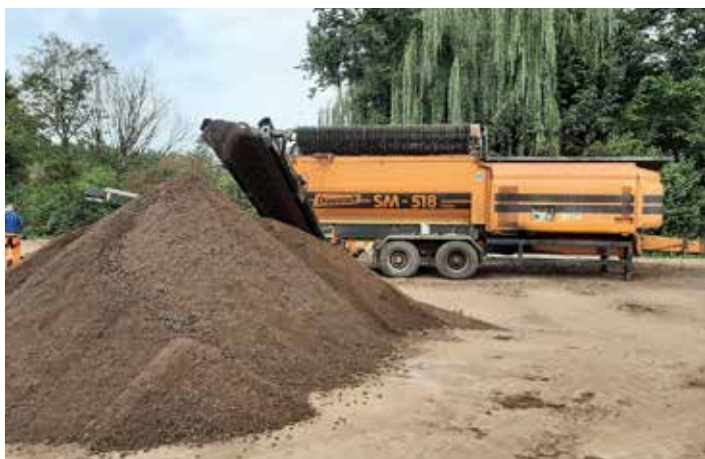
Vom Bauhof angesammelter Humus wurde für den Wiedereinbau gesiebt
