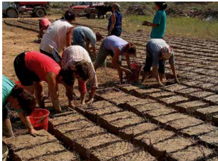
Eine „moderne“ Herstellung von Lehmziegeln in Rumänien. Hier ist klar zu erkennen, dass die Magerung des Lehms durch Stroh erfolgte
