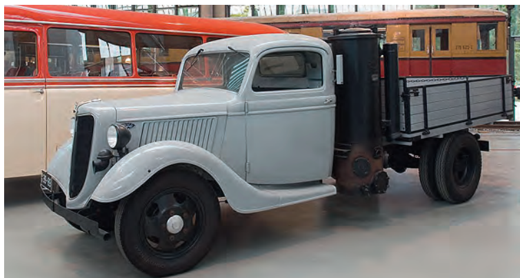
Ein typischer Nachkriegs-Lkw mit Holzvergaser - ein Ford.
